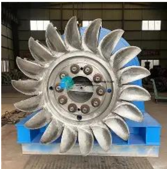
चित्र-7.5B पेल्टन टरबाइन रनर (बकेट/ब्लेड के साथ)
